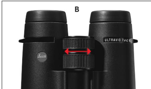
Mit einem der beiden Ringe wird dann das jeweilige Rohr auf ein Objekt scharf gestellt. Anschließend wird an dem anderen Ring das zweite Rohr auf optimale Schärfe eingestellt. Die Reihenfolge kann beliebig gewählt werden. Durch Herunterdrücken des Dioptrienrings wird der eingestellte Wert gespeichert. Der jeweils eingestellte Wert lässt sich bequem an der präzisen Skala ablesen.
